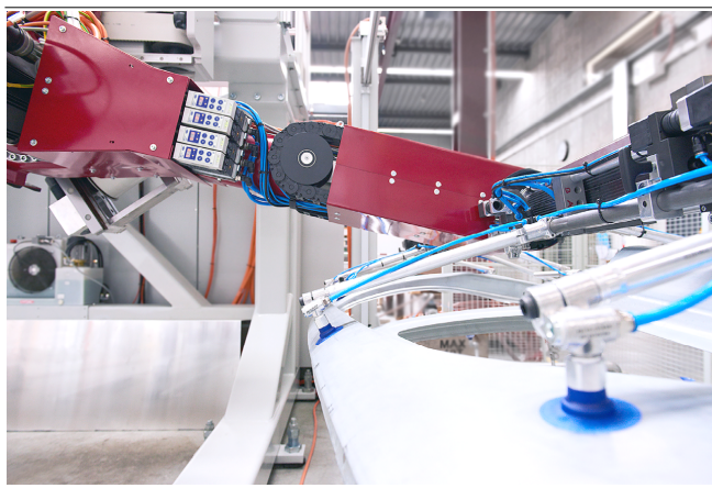
Компактные эжекторы SXMPi класса B для перемещения штампованной детали из листового металла
